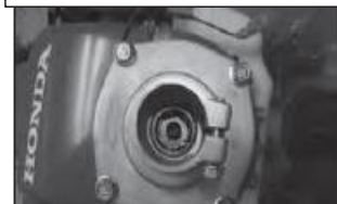
Барабан муфты внутри корпуса сцепления
