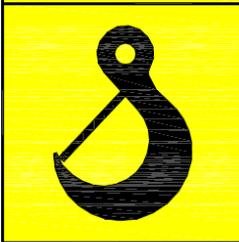
Так обозначено место, за которое можно поднимать машину с помощью крана.
