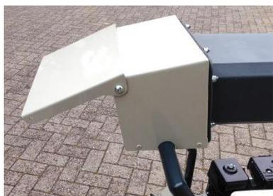
Die Klappe vom Auswurfschacht lässt sich öffnen. Mit der Klappe lässt sie etwas der Auswurf lenken.
