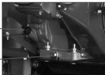
Рис. 10 Проверка уровня масла в картере
