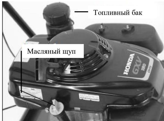
2) топливный бак и масляный резервуар двигателя Honda
