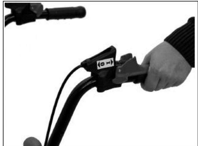
4) С помощью переключающего рычага включите колесный привод.
