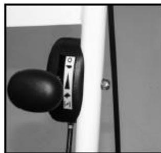
медленная = установить рычаг регулировки подачи горючей смеси на
