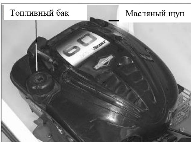
1) топливный бак и масляный резервуар двигателя B&S
