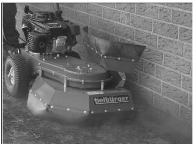
Если поднять вверх боковую защиту, можно производить обработку подметальной машиной вплотную к стене (например, у стены дома, у бордюрного камня)
