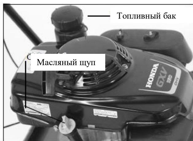
1) топливный бак и масляный резервуар двигателя Honda
