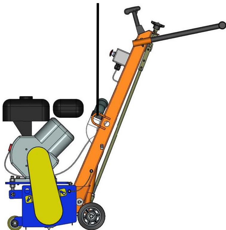
Рисунок 2 – Схема строповки машины
