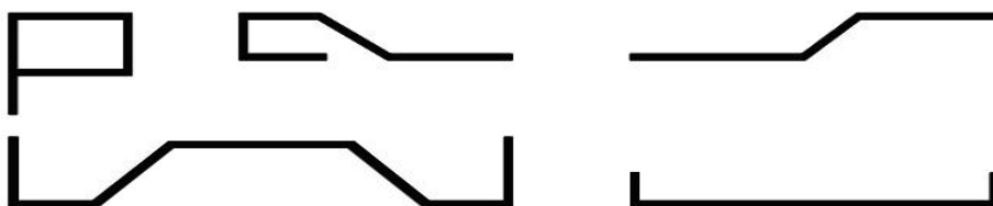
Рис. 5 Формы изгиба арматуры
