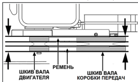
Рис. 23 Проверка соосности шкивов
