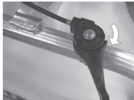
4. Установите регулятор давления в положение «Низкие обороты». Это крайняя позиция регулятора, если повернуть его против часовой стрелки.
