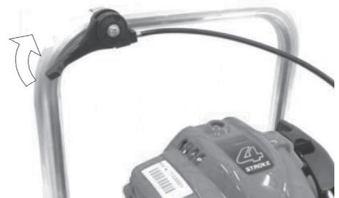
4. Установите регулятор давления в положение низких оборотов. Это крайняя позиция регулятора, если повернуть его против часовой стрелки.
