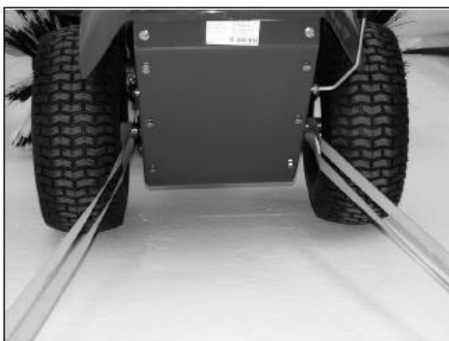
3) В любом случае следует использовать обе точки крепления
