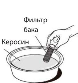
1. Снять крышку топливного бака и осмотреть фильтр.
