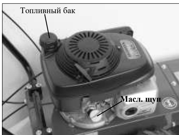
Топливный и масляный баки на двигателе GSV190
