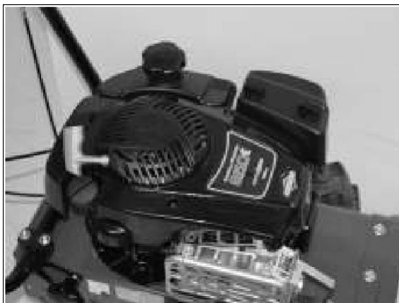
Топливный и масляный баки на двигателе V&S
