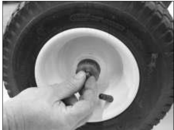
Закрепите винтом с шайбой.
