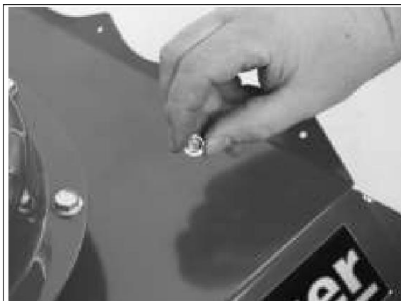
Вставьте винт через отверстие с нижней частью кнопки.
