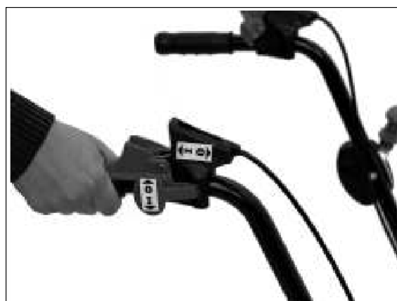
Нажав на этот рычаг, вы активируете привод косильных ножей.
